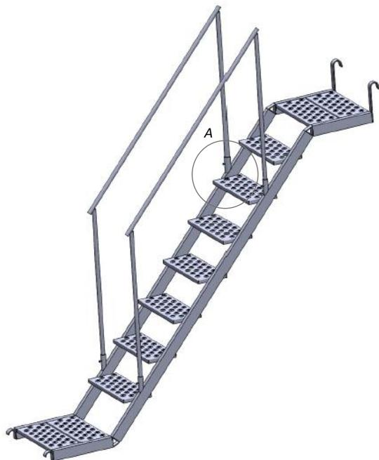
La misma provee acceso cada 2,00 m. de altura en una longitud de 2,50 m. y se fija a la estructura mediante ganchos de acero.
